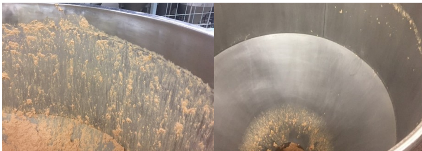
Een saladetrichter die behandeld is met een coating (rechts) levert 60% minder voedselverspilling op na leging in vergelijking met onbehandelde trechters (links)
